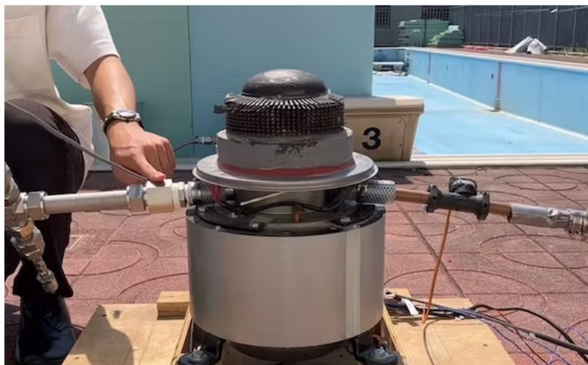
フォルテが開発した積雪発電システム。上部から熱源、横のホースから雪の冷熱を取り込み温度差で発電する
